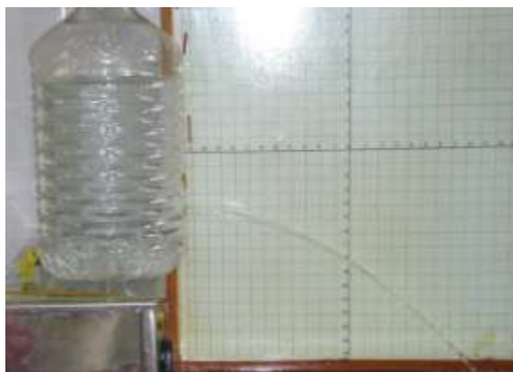
Σχήμα 5. Η πειραματική διάταξη. Το υγρό εκτελεί οριζόντια βολή
