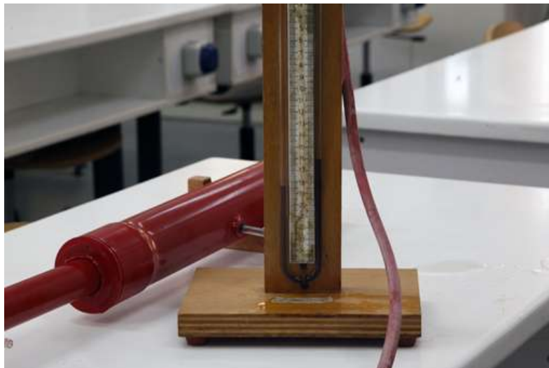
Εικόνα 9. Το αριστερό σκέλος του μανόμετρου έχει συνδεθεί με την πρώτη οπή
