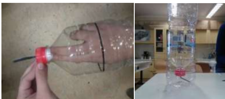
Εικόνα 8. Κατασκευή στηλών για μελέτη μονωτικών στρώσεων
