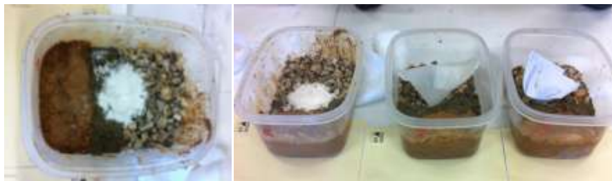
Εικόνα 4. Μοντέλο ΧΥΤΑ για εύρεση μονωτικής συμπεριφοράς υλικών
