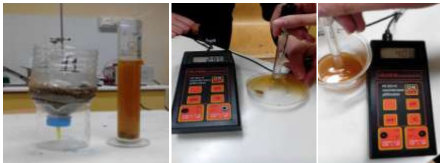
Εικόνα 12. Μελέτη συμπεριφοράς υλικών στρώσης για στράγγισμα οξέων φρούτων
