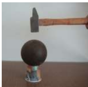
Εικόνα 1. Η μεγάλη αδράνεια της ακίνητης βαριάς σφαίρας προφυλάσσει το χάρτινο κυπελλάκι παρ' όλο το χτύπημα του σφυριού
