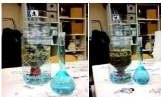
Εικόνα 10. Διαφορετικές στρώσεις υλικών για μελέτη της διαπερατότητάς τους
