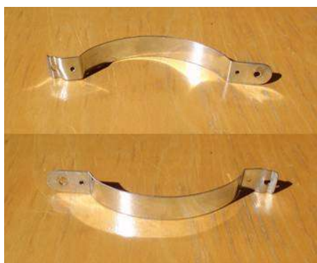
Εικόνα 12. Λυγισμένη λαμαρίνα σε ρόλο κοίλου και κυρτού κατόπτρου
