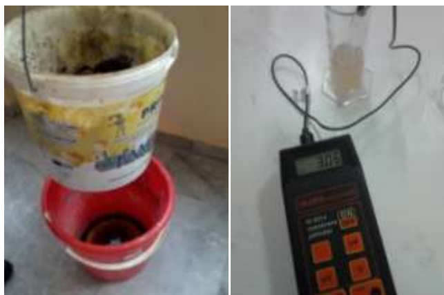
Εικόνα 5. Μέτρηση pH στραγγισμάτων αναερόβιου κομποστοποιητή
