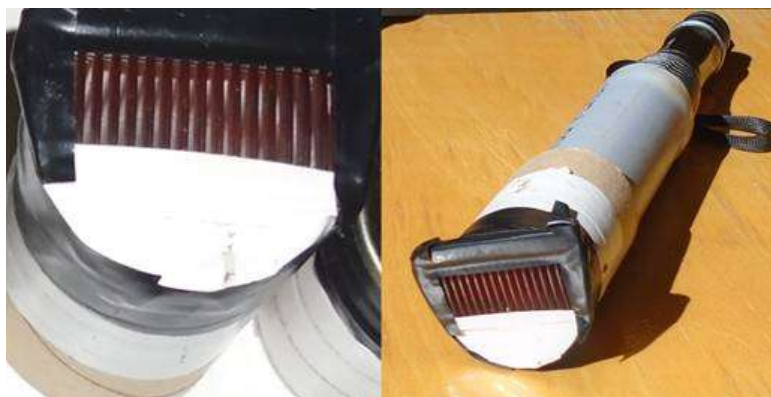
Εικόνα 11. Διάφραγμα με χτενάκι στο σωλήνα του φακού
