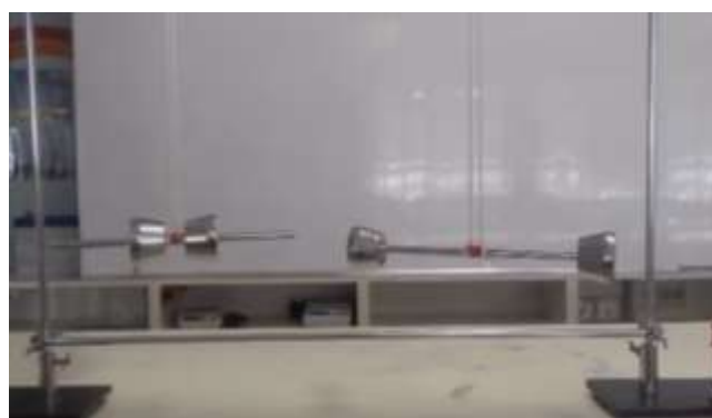
Εικόνα 10. Όταν οι κωνικές βάσεις τύπου A, απέχουν πιο πολύ από το μέσον της οριζόντιας ράβδου, η περιστροφή της ράβδου γύρω από κατακόρυφο άξονα που διέρχεται από το μέσον της είναι πιο αργή
