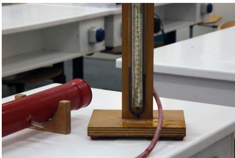
Εικόνα 10. Το αριστερό σκέλος του μανόμετρου έχει συνδεθεί με τη μεσαία οπή
