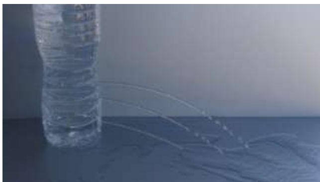
Εικόνα 1. Η φλέβα νερού από την πάνω τρύπα έχει μεγαλύτερο βεληνεκές από τις άλλες δύο
