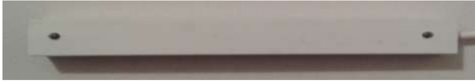
Εικόνα 3. Ολοκληρωμένος αισθητήρας υπερέυθρων με 2 LED στις άκρες του
