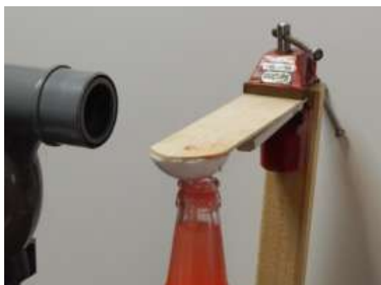
Εικόνα 4. Παρόλο που υπάρχει ρεύμα αέρα δεν παρατηρείται ψεκασμός
