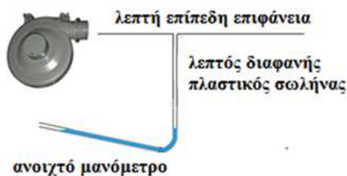
Εικόνα 3. Σταθερό ρεύμα αέρα πάνω από το άνοιγμα του μανομέτρου
