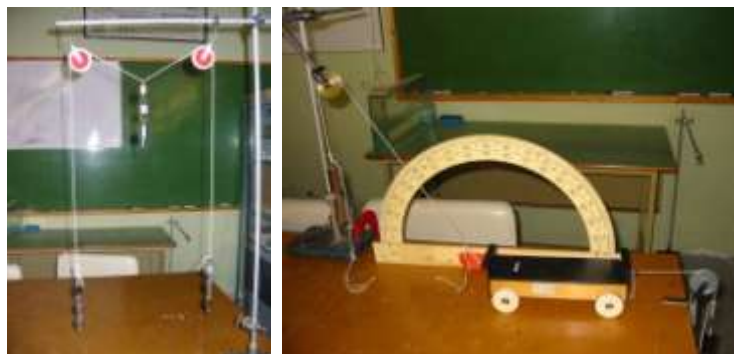
Σχήμα 2. Διατάξεις για τον υπολογισμό της συνισταμένη δύναμης (αριστερά) και συνιστώσας δύναμης (δεξιά)
