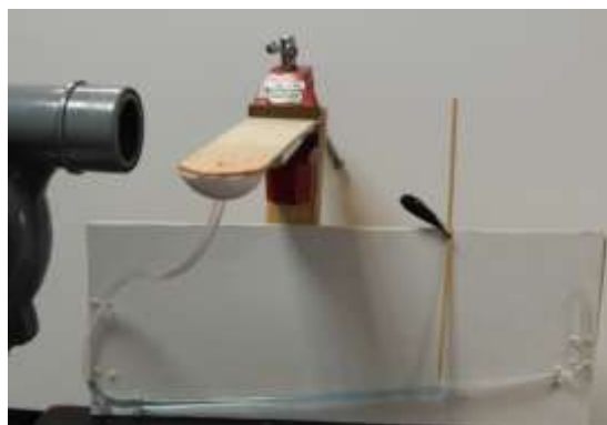
Εικόνα 5. Παρόλο που υπάρχει ρεύμα αέρα δεν παρατηρείται ανύψωση νερού στο μανόμετρο
